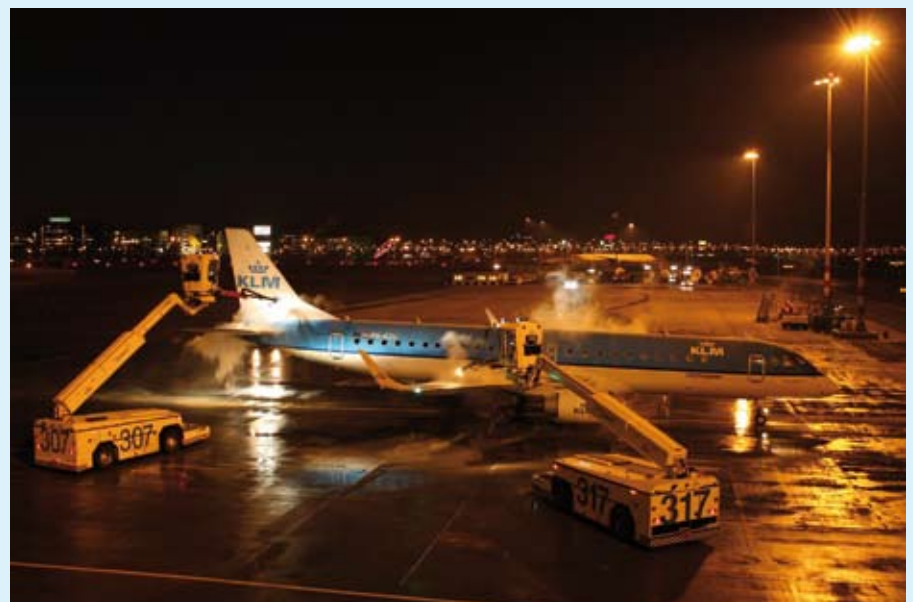
Het ijsvrijhouden van de vliegtuigen (foto: Arjen Piest).
